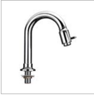
Bocca lavabo ø 25 mm fissa con apertura 1/4 di giro a dischi ceramici, 1/2"
