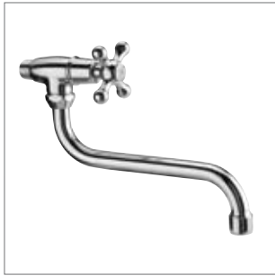
Rubinetto lavello modello pesante da 1/2" con bocca girevole a "S" ø 18x200 mm 1/2" heavy model sink tap with "S" swivel spout ø 18x200 mm Robinet évier 1/2" modèle lourd avec bec orientable à "S" ø 18x200 mm 1/2" valve (art. 671)
