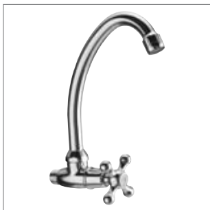
Rubinetto lavello da 1/2" modello pesante con bocca girevole a "J" ø 18x180 mm 1/2" heavy model sink tap with "J" swivel spout ø 18x180 mm Robinet évier 1/2" modèle lourd avec bec orientable à "J" ø 18x180 mm 1/2" valve (art. 671)
