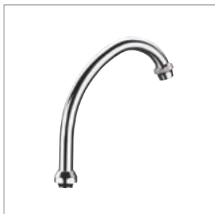
Bocca girevole a "J" ø 18 mm con dado da 3/4" e rompigitto 3/4" "J" swivel spout ø 18 mm with 3/4" nut and antislash
