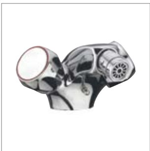
Gruppo monoforo bidet da 1/2" con bocchello orientabile senza scarico con portacatenella 1/2" single-hole bidet mixer with swivel antisplash without pop-up waste with chain holder Mélangeur monotrou bidet 1/2" avec bec à rotule sans vidage avec porte-chainette 1/2" valve (art. 671-E)
