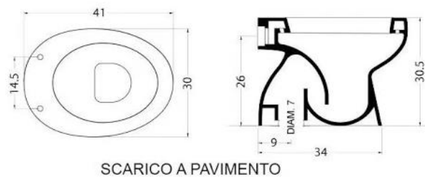
SCARICO A PAVIMENTO
