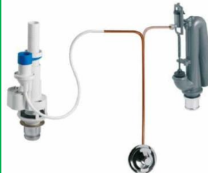
Meccanismo pneumatico a scarico singolo, Adatto alla sostituzione di batterie pneumatiche pre-esistenti su cassette alte in ceramica Completo di tubetto 70 cm per connessione a vecchio tubo in rame Troppopieno regolabile in altezza Vitone in ottone cromato
