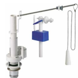
Meccanismo a scarico singolo con pull a perlina Adatto all'installazione su cassette alte in ceramica Troppopieno regolabile in altezza Galleggiante a entrata laterale 3/8" Vitone in ottone cromato
