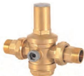
Riduttore di pressione bocchettone maschio laterali, sui due lati per manometro da 1/4" gas. Funzionamento a pistone. Sede acciaio inox 18/10. Pressione max a monte 25 bar, pressione a valle regolabile da 1 a 6 bar, pressione a valle impostata 3 bar in fabbrica.
